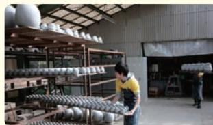
②下塗り：乾燥させた二カワをお湯で溶かし、国産のかき殻を焼いて粉にした胡粉(ごふん)を入れて下塗り用の塗料を作る。だるまの生地の底にヘッタと呼ばれる重りを下塗り用の塗料で接着してから、生地にも塗料を塗って天日で乾燥させる。この下塗りをすることで、生地を保護強化し最後に塗る赤色の発色が良くなる。
