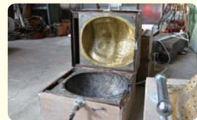
①生地作り：木型を使った生地作りから「真空成形」に代わり製造効率が格段にアップ。再生紙などを水でかくはんした水槽に、だるま型の鑄型が入った箱を浸し、真空ポンプで吸引、鑄型に吸着させる。鑄型の中に厚さ5ミリほどの生地ができる。そつと取り出して表面の肌をきれいに整え、天日で2~3日乾燥させる。
