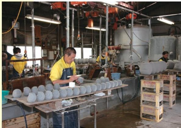
槽の中に、だるまの形をした鑄型が入った箱を浸し、真空ポンプで吸引すると、材料が鑄型に吸着する。箱を引上げて鑄型を開くと厚さ5ミリのだるま型の生地が出来ている。「豆腐よりも柔らかい」という成形したての生地を丁寧にと取り出し表面のキメを整え、天日で2〜3日乾燥させたら完成となる。
