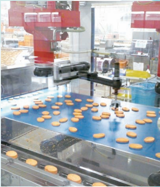
形状や大きさを瞬時に見分け、合格したものを2枚重ねにして 拾い上げる最新のアームロボット
