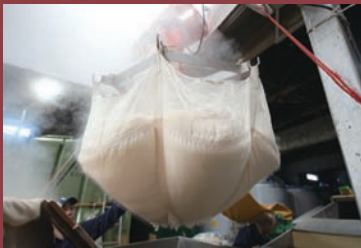
蒸し上がった酒米を蒸籠から引き上げ放冷機へ
